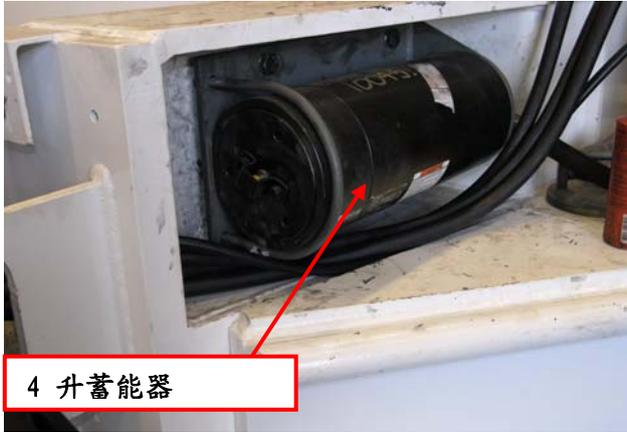
提升缸油路蓄能器是充氮柱塞式蓄能器。该蓄能器实质上是液体压力储存室。它通过克服受压氮气压缩力而储存受压（不可压缩）液压油的势能。该势能供提升缸油路需要时使用。
