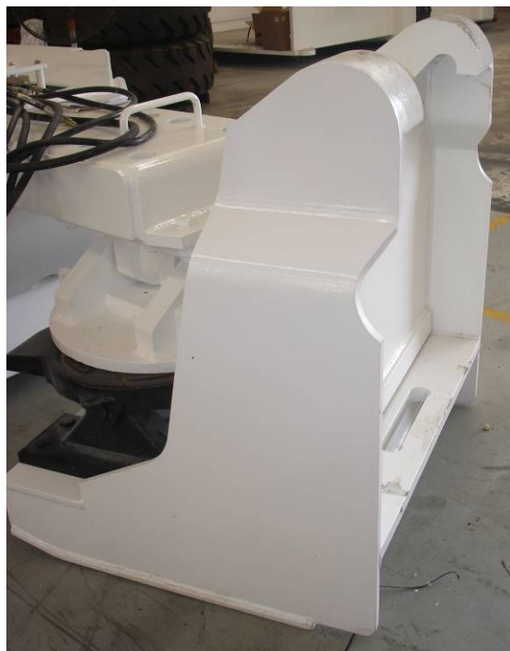
FBL-10 牵引车与第五轮的连接
