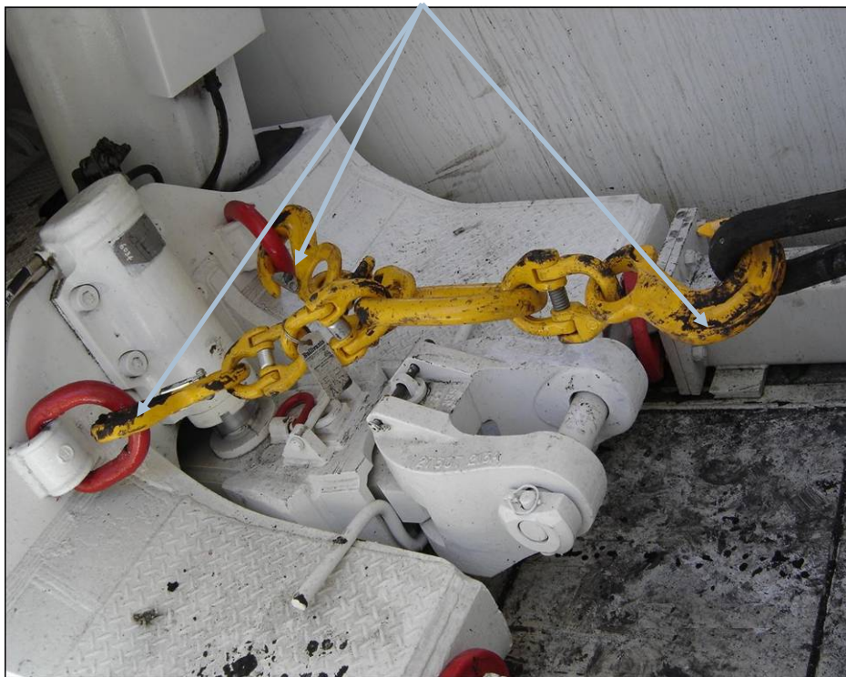
拖拉链与支架起吊环的连接
