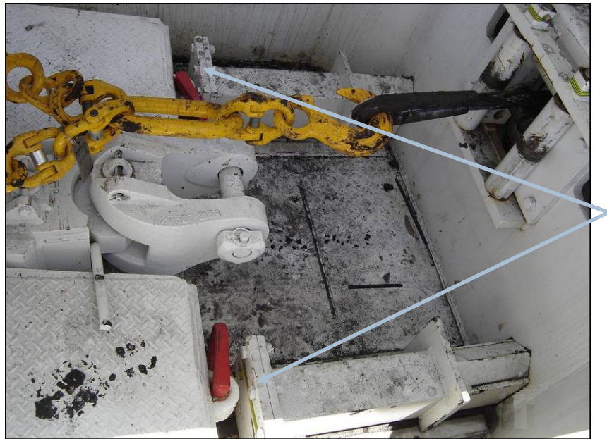
支架顶在拖车的推出油缸上
