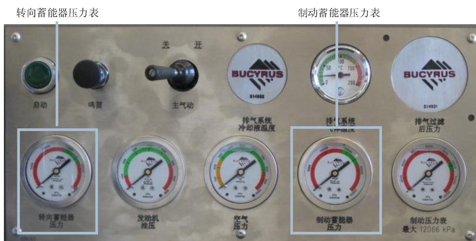
驾驶室右侧控制面板
