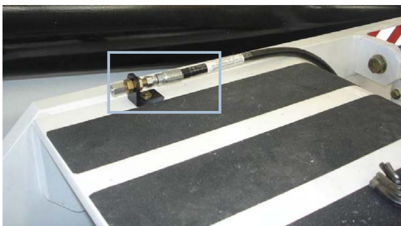
工作平台紧急按钮管路连接点（主机）
