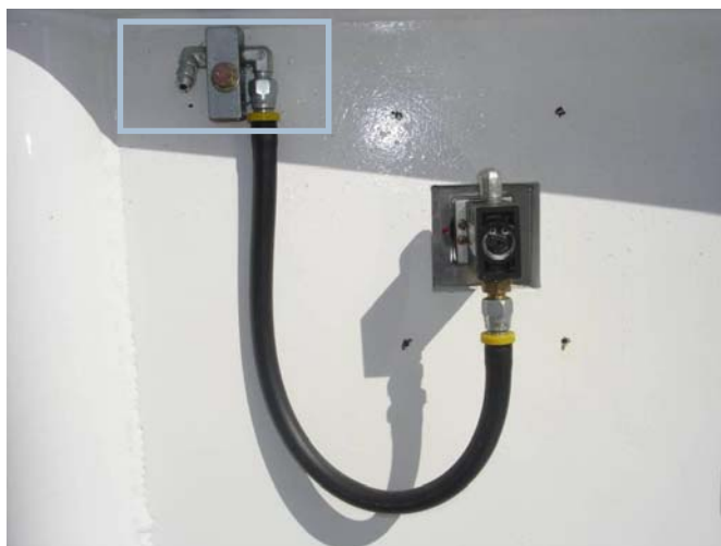
工作平台紧急停止按钮管路连接点
