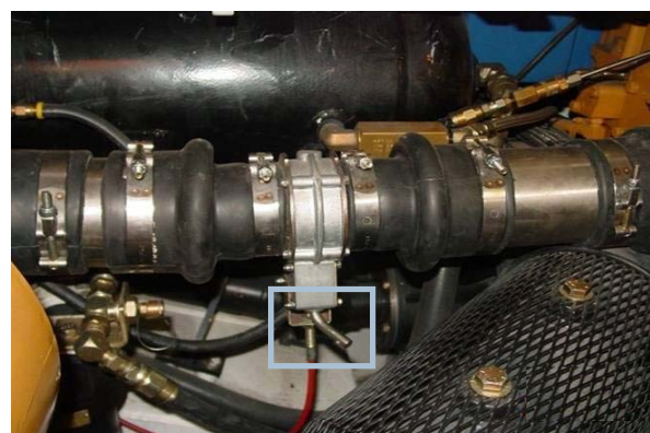
进气管紧急关机阀复位手柄
