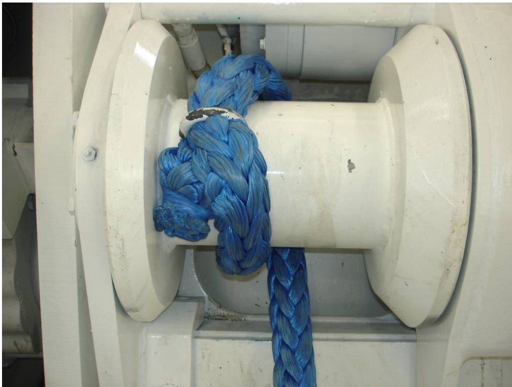
合成式绞车绳(由U型螺栓卡紧)
