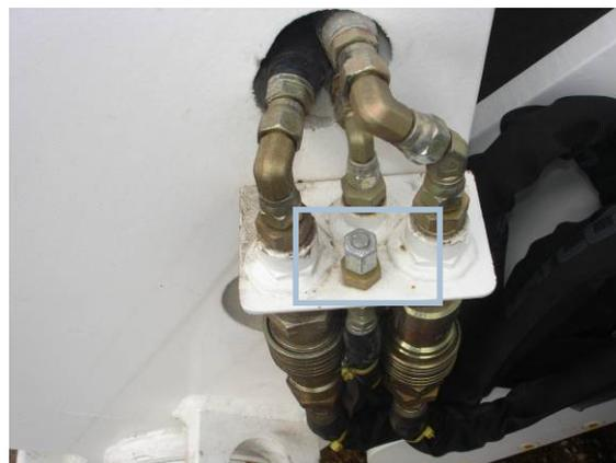
工作平台急停开关软管连接
