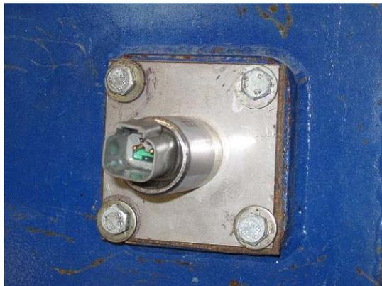
发动机冷却液液位传感器
