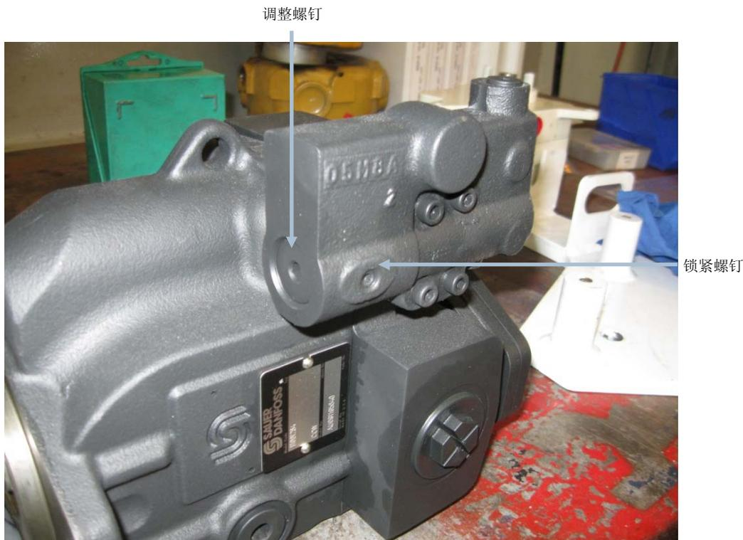
压力补偿式转向和制动泵
