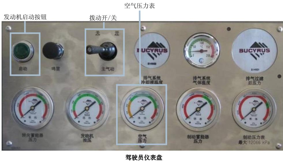
**开/关式搬扭开关:** 开/关式拨动开关把系统的空气供给柴油机控制系统安全回路的启动初始传感器, 此传感器激活柴油机控制系统显示当前的相关状态。当开关处于开的位置时, 开/关式拨动开关也供给到启动回路和驻车制动回路。
