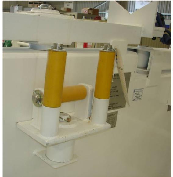
电缆和管道托轮
