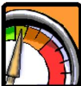
**黄色:** 仪表显示温度或压力低于正常操作范围。如果只是短时间操作，不会立即造成设备的损坏。如果仪表指针持续指示在此区域，驾驶员应该报告维护人员以便处理。
