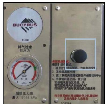
发动机油压检测扭检测阀
