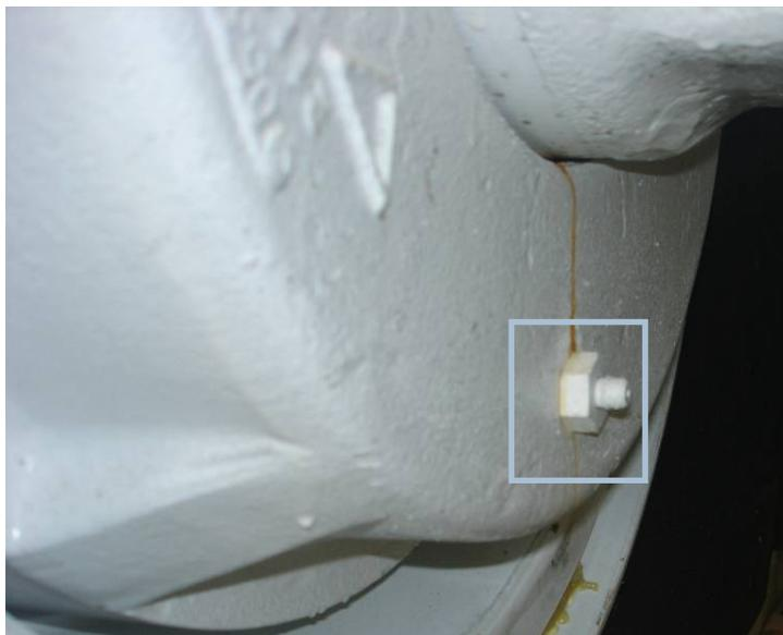
制动器摩擦片磨损指示器
