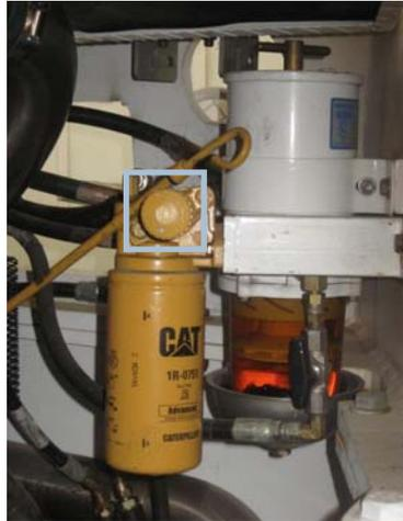
发动机燃油手动注油泵
