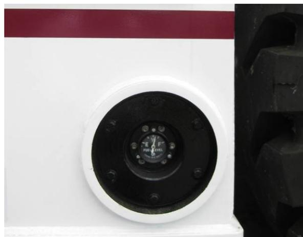
油箱检查门和油位表放水螺堵在下方
